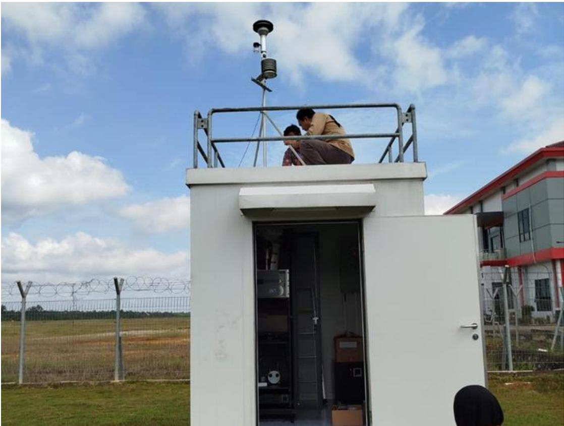
**Gambar 35 Pemeliharaan Peralatan Sistem Operasional Informasi Konsentrasi Partikulat dengan metode sampling (MetOne) atau PM 2.5**
